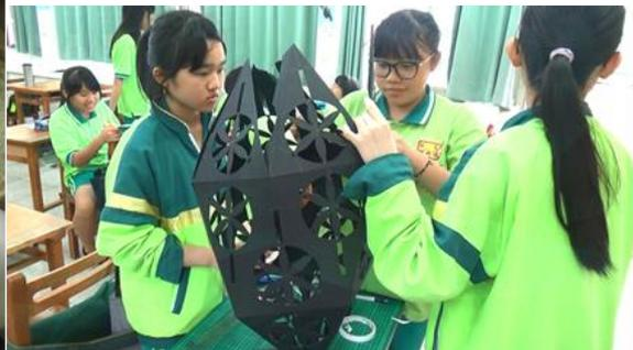
採壓克力板為材料製作燈飾的組別，需透過卡典西德並將裝飾圖形繪製上去，於雕刻後再呈現於燈飾中。
