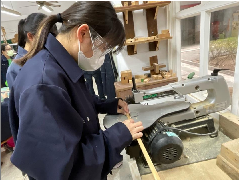
小夜燈木製底座，線鋸機裁切製作過程
