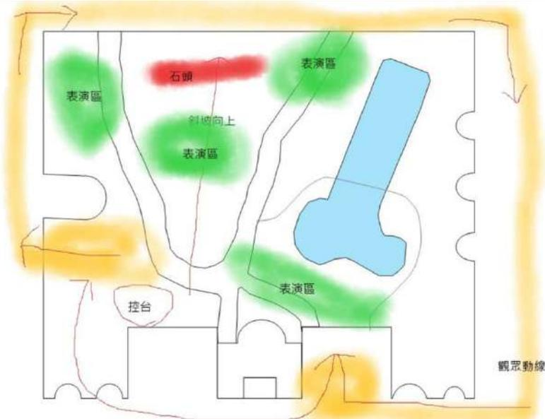
簡單線條處理後，留下步道、水池、四周走廊，初步歸納出可能的表演區、障礙物，以及控台設置位置、觀眾動線處理。
